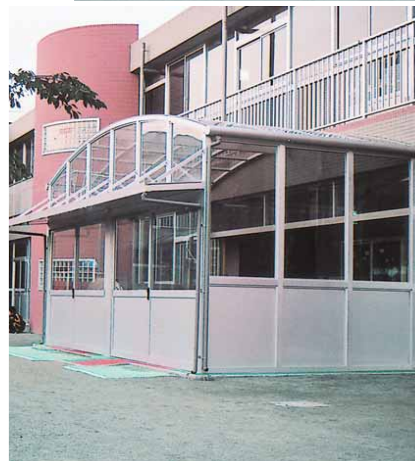
玄関風除室 (埼玉県川越市 藤原白百合幼稚園) [間口:5.5M、奥行:3.0M、被覆材:ポリカーボネート板 t-3.0、5.0(耐候処理)、 アルミ複合板t-3.0]
